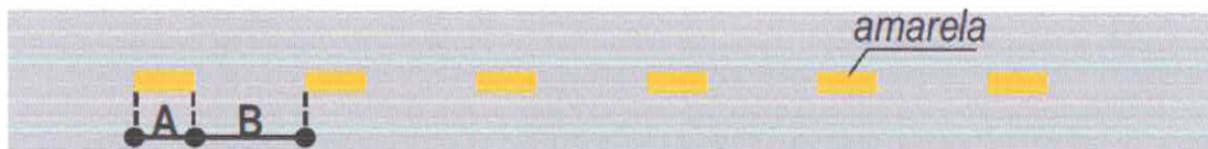
Detalhe Faixa Seccionada.
